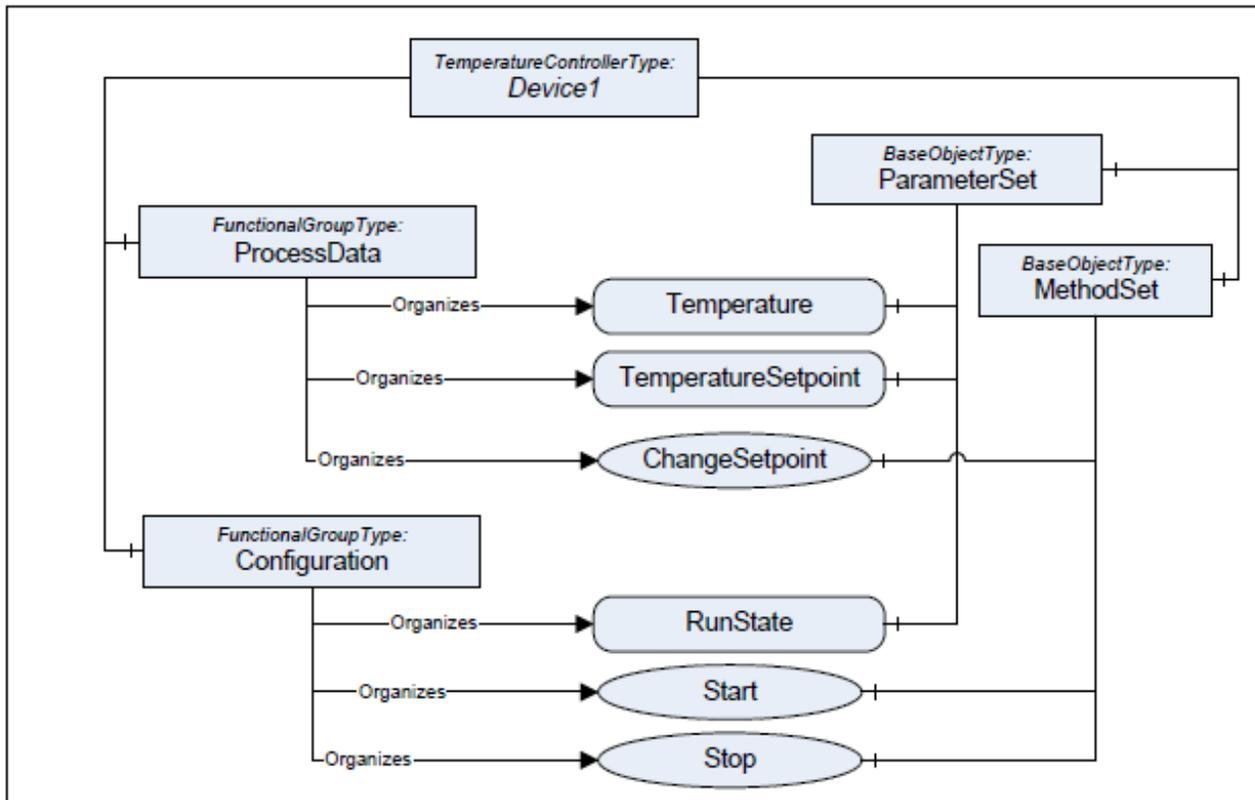
Figure 8 OPC UA Device Example
